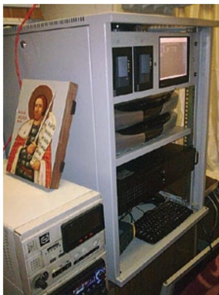
➤ В стойке: внизу – сервер, далее – два ресивера, вверху слева – модуль управления спутниковыми тарелками, справа – маленький монитор (удобнее подключаться к системе с ноутбука).
