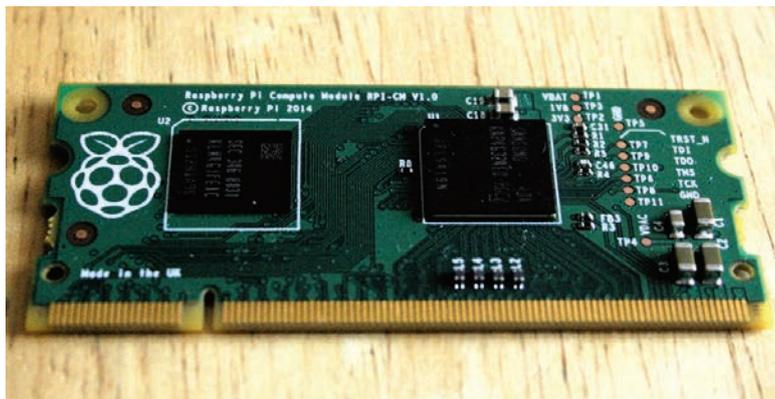
» Compute Module — маленькая плата, размером с SODIMM, предназначенная для интеграции в промышленные приложения.
